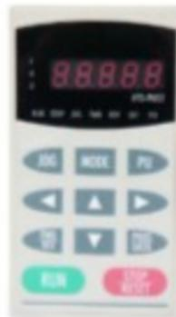
Пульты типа VFD-PU02/PU-06 (см. также главу "Панели управления") соединяются по интерфейсу RS-485 с помощью телефонного кабеля и может быть вынесен на дистанцию до 20м (или до 300 м при использовании автономного источника питания +15В). Кроме обычных функций управления приводом, отображения текущего состояния привода (частота, ток, напряжение и др.), редактирования параметров пульты обеспечивают возможность копирования настроек одного преобразователя на другой.
